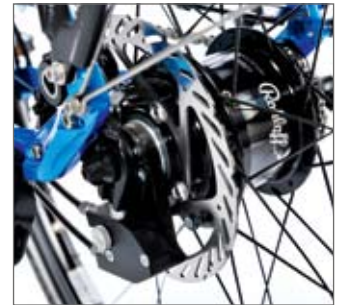
Premiumschaltung trifft Premiumbremse: Rohloff 14-Gang mit Magura „MT4“-Scheibenbremse.
