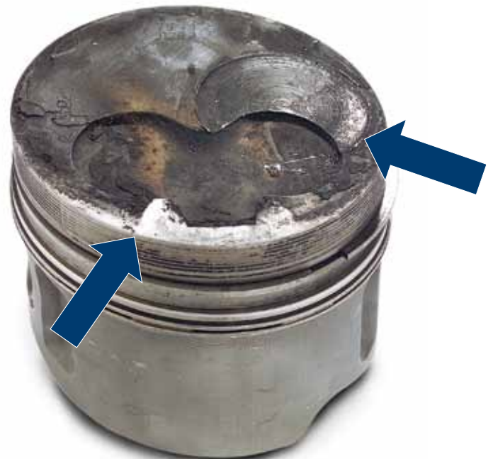
Abb. 4 Anschlagspuren durch motorische Überhitzung
