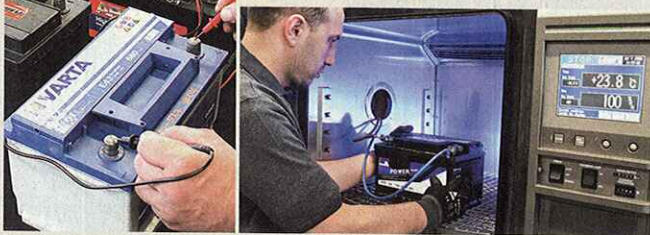
Überprüfung der Ruhespannung
