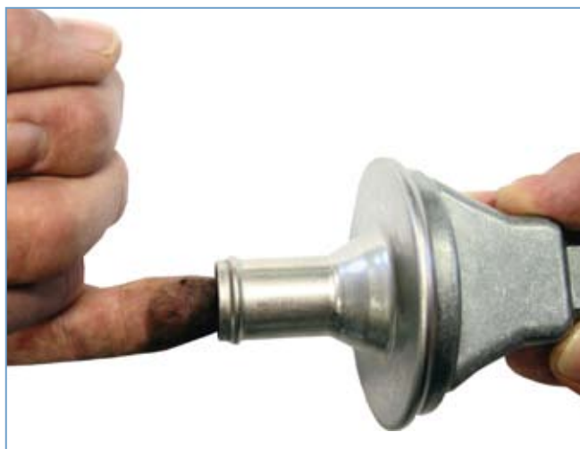
Abb. 3 Einfache Prüfung des Rückschlagventils
