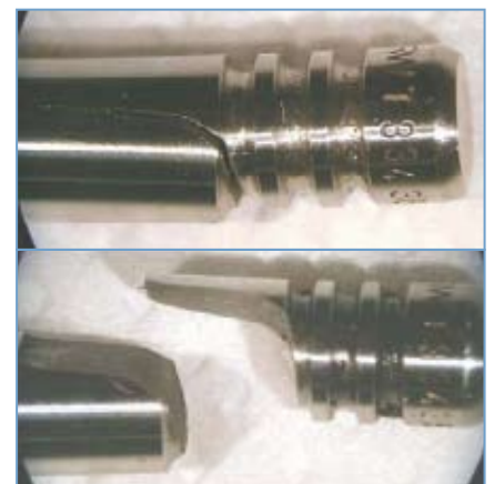
Abb. 2+3 Gebrochene Ventile [Text & Bilder: Federal Mogul]
