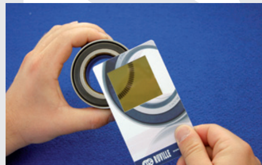
Einsatz der Detector-Card am Beispiel eines FAG-Sensorlagers mit Erkennung des Impulsgeberrings im Bild „unten“
