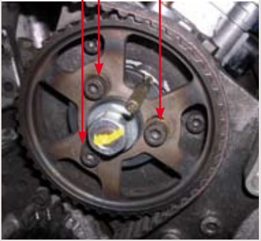
Abbildung 3: Zwei verschiedene Schraubentypen in den Langlöchern der Kurbelwelle
