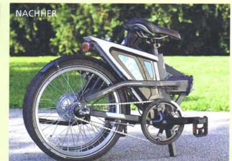
NACHHER So sieht das Rad gefaltet aus: Durch die parallelen Räder und die durchgeschobene Sattelstütze ist es relativ kompakt. Die Faltpedale machen das Paket schmal und lassen es im Kofferraum relativ plan liegen. Tipp: Wer den ohnehin leichten Akku vor dem Anheben herauszieht, braucht weniger Gewicht lupfen.
