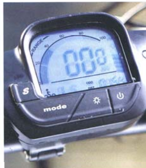
Das neue Display in Daumennähe ist gut lesbar und zu bedienen. Segmentfelder zeigen die Restreichweite abhängig vom gewählten Unterstützungsmodus an. Das Licht lässt sich hier per Knopfdruck einschalten, ein Helligkeitssensor macht das aber auch automatisch.
