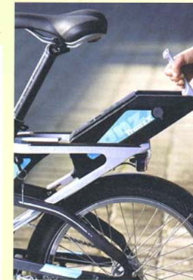
Relativ schmal, leicht ausziehen, kontaktiert sich beim Einschieben selbst, ist abschließbar und dank Außenladebuchse variabel zu laden: der 36 V / 6,6 Ah-Akku bietet eine Kapazität von knapp 240 Wh. Eine Komplettladung soll 3,5 Stunden dauern.
