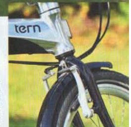
Beste und definitive Verzögerung – auch weil die Vorderradbremse „auflaufend“ montiert ist.
