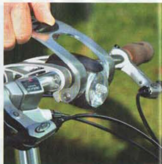
Kompetent gemacht und optisch ein Genuss: der Vorbau-Schnellspanner lässt sich mit dem Daumen entriegeln und aufklappen für gleichzeitiges Einstellen der Lenkerreichweite und Griff-Stellung.
