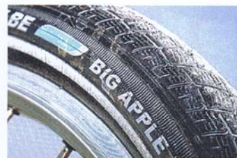
Die dicken Reifen sind als Federung effektiver als billige Federgabeln
