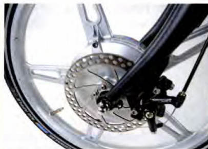
Kräftiger Nabenmotor im 5-Speichen-Vorderrad. Daneben: klasse Scheibenbremse. Unten: Bogenlenker mit mittigem Display, über ein Bedienpanel (links, Griff) ohne Hände vom Lenker nehmen zu bedienen!
