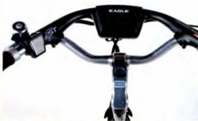
Kräftiger Nabenmotor im 5-Speichen-Vorderrad. Daneben: klasse Scheibenbremse. Unten: Bogenlenker mit mittigem Display, über ein Bedienpanel (links, Griff) ohne Hände vom Lenker nehmen zu bedienen!
