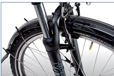
• Komfortabler: SR-Suntour Federgabel mit viel Federweg (100 Millimeter) und breite Schwalbe CX Comp-Pneus am TrengaDE.
