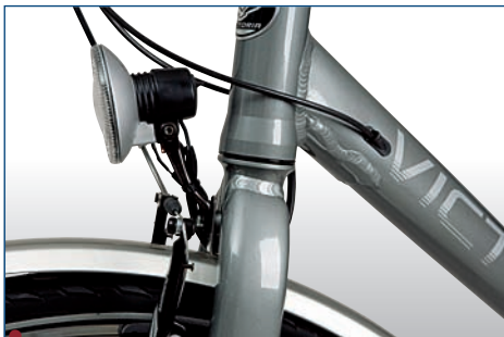
• Schöner Rahmen: Fließende Übergänge und durchgehend in den Rohren verlegte Außenhüllen am Victoria.
