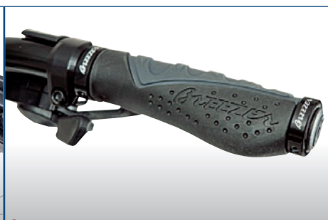
• Leider nicht selbstverständlich: per Schraube geklemmte Ergo-Griffe am Breezer (auch Poison).
