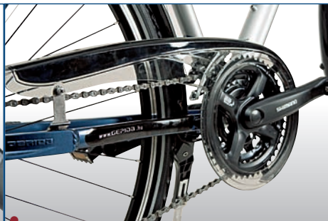
• Praktisch im Alltag: vollwertiger Kettenschutz bei Gepida (auch Bergamont, Victoria).
