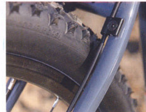
Solide Lösung: angeschraubte Kabelführungen
