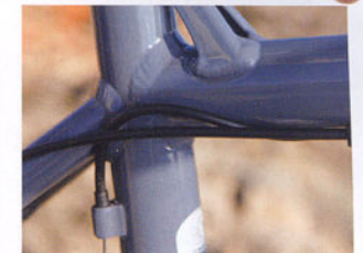
Eigenwillige Verstärkung am Sitzrohrstummel
